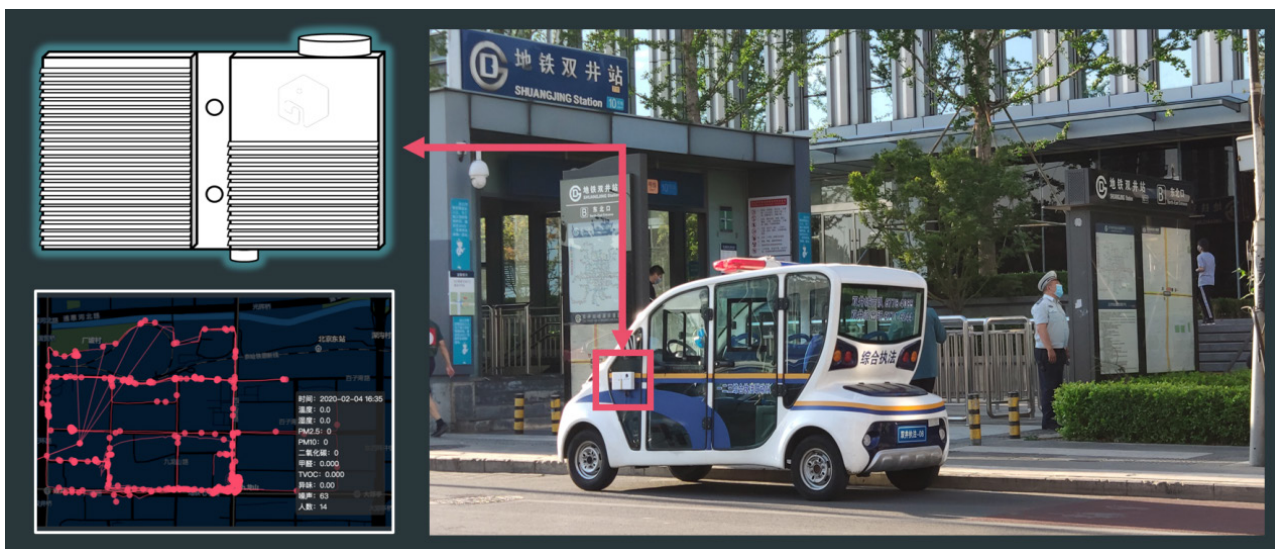
图 30：安装在城管执法车上的环境传感器
